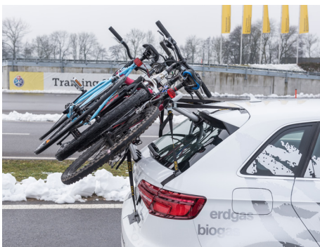
Der straffe Sitz der Spanngurten sollte nach etwa 50 km Fahrt kontrolliert werden.
