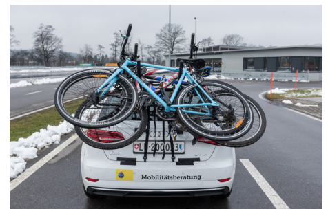
Bei der Beladung ist darauf zu achten, dass die Beleuchtung und die Nummer sichtbar bleiben.
