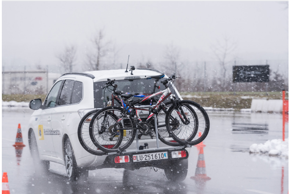
Bei der Montage an der Anhängerkupplung ist auf ausreichende Klemmkraft zu achten, sonst verdreht der Träger bei Ausweichmanövern.
